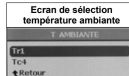
**Pour la température extérieure**, si aucune sonde radio n'est connectée, l'appareil affichera un écran permettant de saisir manuellement la température extérieure. A l'inverse, si plusieurs sondes radios sont connectées, l'appareil affichera un écran de sélection permettant de choisir la sonde radio pour le calcul du coefficient U.
